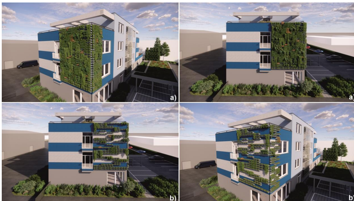
Obr. 4.8 Návrh vegetačnej steny na fasáde objektu
